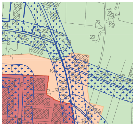
Figura 1: errore sedime stradale senza retinatura e mancata fusione delle fasce di pertinenza stradali nelle intersezioni della stessa classe.
