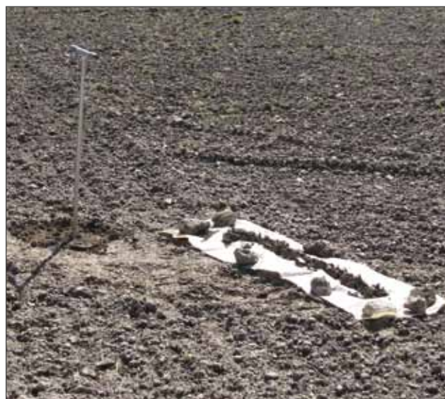
Fig. 3.3: Trivellata eseguita con trivella olandese manuale; le carote di terreno estratte vengono posizionate su di un telo per consentire la descrizione degli orizzonti pedologici e il campionamento.
